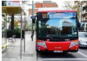
Un autobús urbano de 280 CV, que hace 50.000 km anuales en condiciones de tráfico muy severas, utiliza **28.000 kg de combustible al año (equivalente a 25 coches)**.
