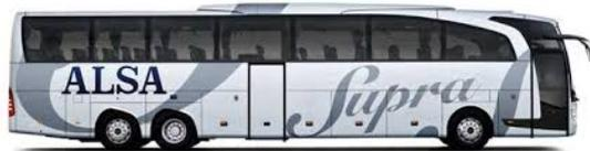
Un autocar de largo recorrido y 400 CV, que recorre 400.000 km anuales, utiliza **112.000 kg de combustible (3 camiones, 4 autobuses, 100 coches)**.
