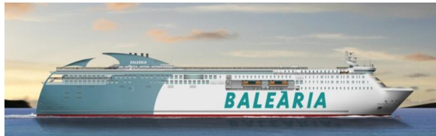
Estará propulsado por motores dual fuel que podrán funcionar con gas natural o diesel, permitiendo a la empresa reducir sus emisiones de CO<sub>2</sub> más de un 30%.
